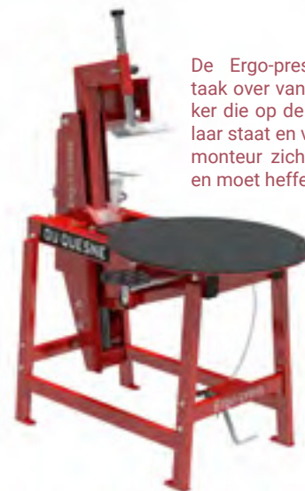
De Ergo-lift tilt het wiel omhoog tot in een horizontale stand.
