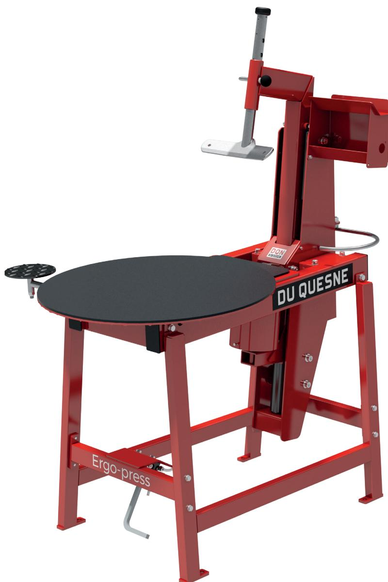
L'Ergo-Press est l'élément central de la gamme "Ergo-Line". Ce détalonneur pneumatique sur table est synonyme de confort, efficacité et sécurité.
