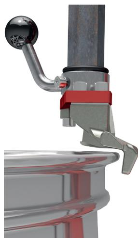
Le positionnement de la tête de montage et la prise de distance automatique de l'outil à la jante se fait en un seul mouvement. De plus, le réglage se conserve d'une roue à l'autre.
